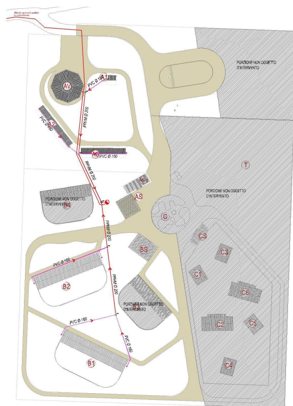
Figura 1 - Planimetria sistema drenaggio acque reflue
